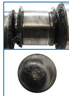
**Symptome:** Starker Verschleiß von einem oder mehrerer Nocken. Oberfläche des Stößels konkav verformt, Ränder evtl. ausgebrochen.
