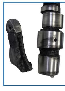
**Symptome:** Verkohlte Ölrückstände auf Nockenwelle, Schlepphebeln und Stößeln.
