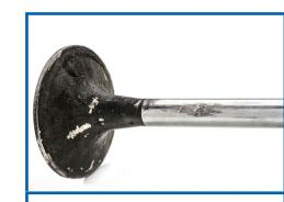
Kompression, Mechanischer Bruch aufgrund festhängender Ventile. **Ursache:** Unzureichende Schmierung bedingt verursacht Fressverschleiß oder Metallabtrieb. Dies
