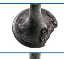
**Ursache:** Zu geringes Ventilspiel, Ventilschaft hängt fest, schlechter/ ungleichförmiger Sitz oder Fehlstellung in der Ventileinheit. Überhitzung durch Frühzündung. Übermäßiger Ölkohleaufbau, Abflocken von der Tellerfläche, Ausbildung einer Undichtigkeit. Harte Kohlenstoffpartikel graben sich in die Sitzfläche ein, bis genügend Unebenheiten zusammenkommen und einen Gasdurchtrittspfad bilden. **Abhilfe:** Kontrollieren, dass das Ventilspiel
