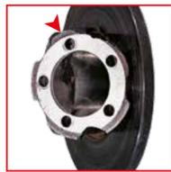
**AUSSEHEN** Nabenkontaktfläche gelöst oder verformt.
