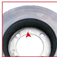
**AUSSEHEN** Verformung der Nabenkontaktfläche und/oder Risse um Fixierbohrung.
