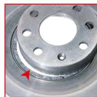
**AUSSEHEN** Ablösen des Bremsscheibentopfs von der Bremsfläche.
