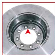
**AUSSEHEN** Nabenkontaktfläche verformt, und/oder Risse um die Aufnahmebohrungen.
