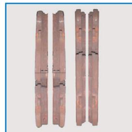
**ERSCHEINUNGSBILD** An der selben Achse montierte Bremsbeläge weisen einen unterschiedlichen Verschleiß auf.
