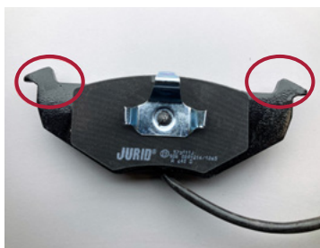
Seitenführungen des Bremsbelags
