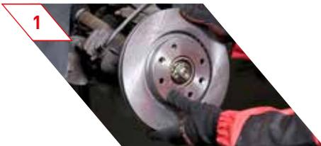
**BESCHREIBUNG** Ein tiefes Geräusch mit einer Frequenz unter 300 Hz. Dies wird normalerweise von Makrovibrationen einer Bremsystemkomponente, z.B. der Bremsscheibe, verursacht
