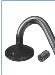
**Síntoma:** Ruido mecánico excesivo, vástago doblado y posible desprendimiento del cabezal.
