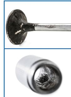
**Síntoma:** Bajo rendimiento debido a una compresión insuficiente. Rotura mecánica debido al atasco de las válvulas.
