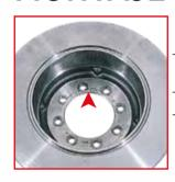
SÍNTOMA Superfi cie de contacto con el buje deformada o aparición de grietas alrede- dor de los orificios de fijación
