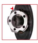
SÍNTOMA Desprendimiento o deformación de la superficie de apoyo del disco con el buje
