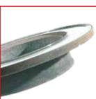
SÍNTOMA Desgaste excesivo. El espesor del disco es menor que el mínimo recomendado por el fabricante (MIN TH)
