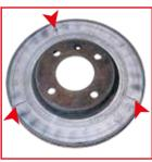
SINTOMA Fracturas radiales o manchas azules correspondientes a los orificios de ventilación CAUSA Las manchas azules son el síntoma de un aumento de las grietas, producidas por un
