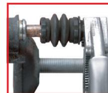
**APARIENCIA** Desgaste desigual de las pastillas de freno en una de las pinzas de freno
