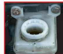
**APARIENCIA** Comportamiento anormal del pedal de freno Líquido de frenos de color marrón, contaminado
