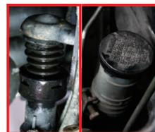
**APARIENCIA** Fugas ó partes húmedas en el cilindro maestro o en el cilindro esclavo
