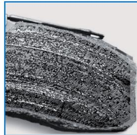
**ASPECTO** Material de fricción de las pastillas contaminado.
