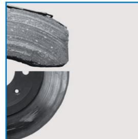
**ASPECTO** El material de fricción tiene contaminación superficial metálica.
