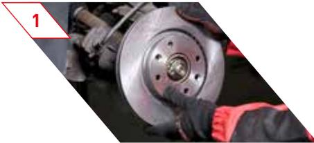
**DESCRIPCIÓN** Un ruido profundo con frecuencia por debajo de 300 Hz. Normalmente se origina a partir de macrovibraciones de un componente del sistema de frenos, por ejemplo, el disco
