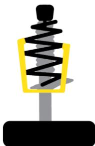
3. Una vez retirado,  **fija la unidad completa al banco de trabajo** y, a continuación,  **utiliza un compresor de muelles para comprimir el muelle de la columna de suspensión** y liberar la tensión ejercida sobre el kit de montaje superior. En algunos modelos de vehículos, el muelle helicoidal debe mantenerse comprimido para poder retirar el conjunto de la columna de suspensión del vehículo.
