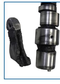
**Aspect :** accumulation d'huile carbonisée sur l'arbre à cames et les culbuteurs.
