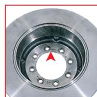
**ASPECT** Déformation de la surface de contact avec le moyeu et/ou fissures autour des trous de montage
