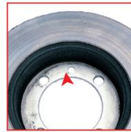
**ASPECT** Déformation de la surface de contact avec le moyeu et/ou fissures en circonférence
