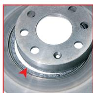
**ASPECT** Détachement du bol du disque de la piste de freinage
