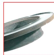
**ASPECT** Usure excessive. L'épaisseur du disque est inférieure à l'épaisseur minimale recommandée par le fabricant
