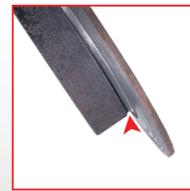
**ASPECT** Rainures profondes entre le bol et la surface du disque
