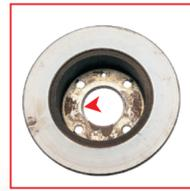
**ASPECT** Impuretés et/ou corrosion sur la surface du moyeu
