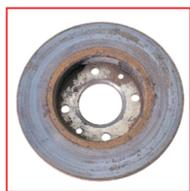
**ASPECT** La souillure de la surface du disque - glaçage et/ou taches sombres
