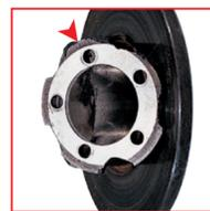
**ASPECT** La surface de contact avec le moyeu est détachée ou déformée
