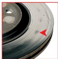
**ASPECT** Usure irrégulière des surfaces de freinage. Points bleus au centre de la piste de freinage. Apparition éventuelle de fissures
