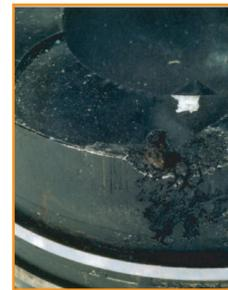
**Symptôme :** Perte de puissance, émission de vapeurs par le reniflard. Fumée d'échappement.
