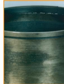
**Symptôme :** Gaz de combustion dans le liquide de refroidissement, bruit moteur, destruction éventuelle de la chemise.
