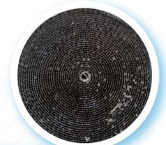
Monolithe partiellement obstrué en raison d'un mélange riche en air. Filtrés à air encrassés, problèmes d'admission et fuites d'air en amont de la sonde lambda sont souvent les causes de ce problème.
