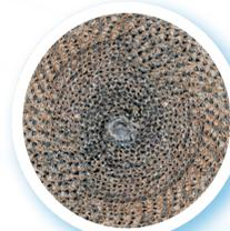
Monolithe intégralement obstrué par des dépôts de phosphore. Ceci est le résultat d'un moteur brûlant plus d'1 litre d'huile au 1.000 km (problèmes d'usure des segments de piston par exemple).
