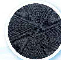
Pollution chimique du monolithe due à l'utilisation du plomb, provenant généralement de l'essence au plomb ou d'additifs non conçus pour une utilisation sur des véhicules catalysés.
