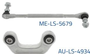
Les biellettes de barre stabilisatrice dont les pivots sont décalés de 150° (seulement 30° de moins qu'une pièce entièrement symétrique ...) sont de bons exemples : les mécaniciens pourraient facilement inverser la position G/D, sans avoir à appliquer une force anormale lors de l'installation. Cette erreur d'installation provoque rapidement des bruits de claquement, pouvant aller jusqu'à la sortie du pivot de son logement.
