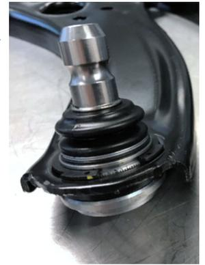
Néanmoins, ce type de joint à rotule ne peut être remplacé indéfiniment. En effet, les opérations répétitives de démontage/pressage affectent de manière significative le diamètre et la rondeur du trou du bras dans lequel la rotule est pressée, en particulier lorsque le corps du bras est en tôle d'acier.
