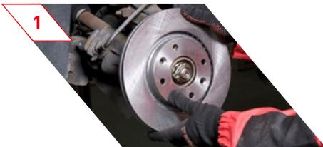
**DESCRIZIONE** Un rumore profondo con frequenza inferiore ai 300 Hz. Normalmente deriva dalle macro-vibrazioni di un componente dell'impianto frenante, es. il disco
