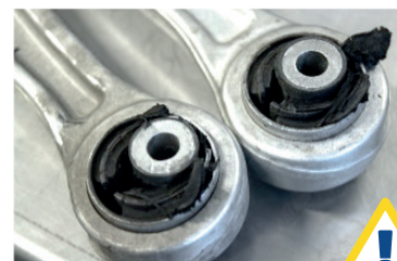
Usura precoce delle boccole del braccio oscillante.
