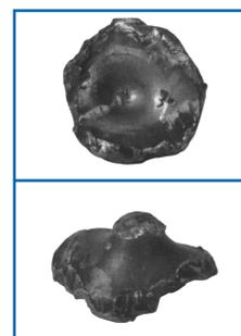
**Признаки:** Жесткая работа двигателя с внезапным механическим шумом.
