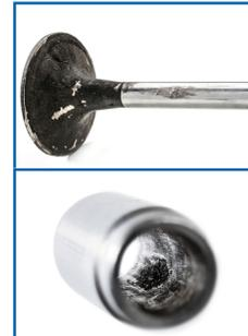
**Признаки:** Снижение мощности из-за низкой компрессии. Механическое повреждение из-за заклинивания клапанов.
