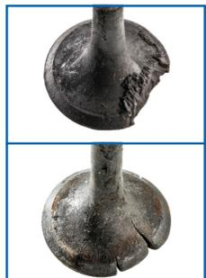
**Признаки:** Потеря мощности. Перебои в работе двигателя.
