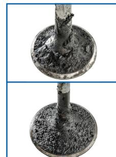
**Признаки:** Затрудненный пуск двигателя. Потеря мощности. Дым синего цвета из выхлопной трубы (при закрытой дроссельной заслонке).
