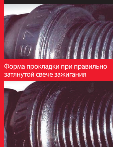
«Форма прокладки при недостаточно затянутой свече зажигания»
