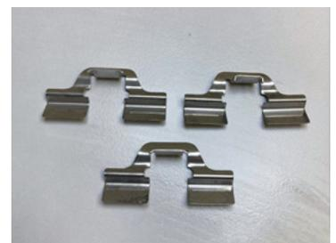
Пружинные фиксаторы колодки
